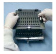
7. Zum Schluss platzieren Sie den auswechselbaren Kapsel-Einsatzboden in den Einfüller. Sie sind jetzt fertig und können sofort eine neue Größe füllen.
