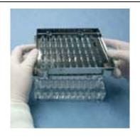
2. Ersetzen Sie es mit dem auswechselbaren Deckblech, richten Sie die Markierung im Boden nach dem Positionierloch im Deckblech aus. Befestigen Sie schließlich alle Teile mit Hilfe von Handschrauben wieder.
