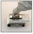
11. Verwenden Sie die Stopfvorrichtung, um die Kapseln zu packen. Verteilen Sie dann das restliche Pulver vom Vorratsbehälter in die Kapselkörper. Alle Kapselkörper sind jetzt gefüllt. Pulver-Einsatzboden entfernen.
