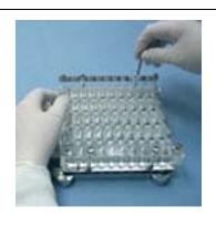
Drehen Sie den Orienter um und entfernen Sie die 4 Handschrauben vom Boden. Entfernen Sie das Deckblech vom Orienter.
