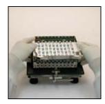
3. Öffnen Sie die Einfüller-Verriegelungsplatte und platzieren Sie die Orienter-Positionierfüße in die Fülllöcher des Einfüllers mit der Markierung "I".
