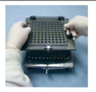
**3.** Entfernen Sie dann den Kapsel-Einsatzboden vom Einfüller.
