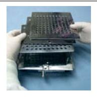
6. Legen Sie zuerst das Blech mit der Markierung "a" in die Positionierstifte, merken Sie sich die "L"- und "R"-Markierungen in den oberen Ecken. Platzieren Sie dann das Blech mit der Markierung "b" und zum Schluss das Blech "c" mit der Markierung in der jeweiligen Reihenfolge.
