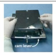
Heben Sie die Distanzplatte heraus, um Sie durch die auswechselbare Distanzplatte zu ersetzen. Stellen Sie sicher, dass der Betätigungshebel zur Waagerechten (3-Uhr-Lage) zeigt.
