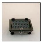
5. Orienter entfernen. Die Kapseln befinden sich in jeder zweiten Reihe des Einfüllers
