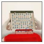
2. Heben Sie die Sperrvorrichtung hoch und schütten Sie die überflüssigen Kapseln weg.
