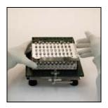
**4.** Drücken Sie den verschiebbaren Teil des Orienters nach links, um die Kapseln in den Einfüller fallen zu lassen.
