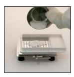
Platzieren Sie den Pulver-Einsatzboden in den Einfüller mit Hilfe der Positionierstifte und gießen Sie das Vorgemessene Pulver ein.
