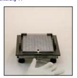
7. Zum Sichern schließen Sie die Einfüller-Verriegelungsplatte und den verschiebbaren Spannbügel. Platzieren Sie den Daumen hinter den runden Hebelteil und drücken Sie den Betätigungshebel, um die Kapselkörper im Einfüller festzuhalten.
